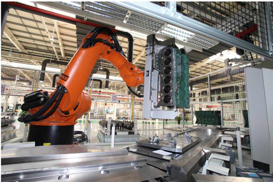
Bild 1: Ein Greifer des Typs 1 beim Umdrehen eines Zylinderblocks
