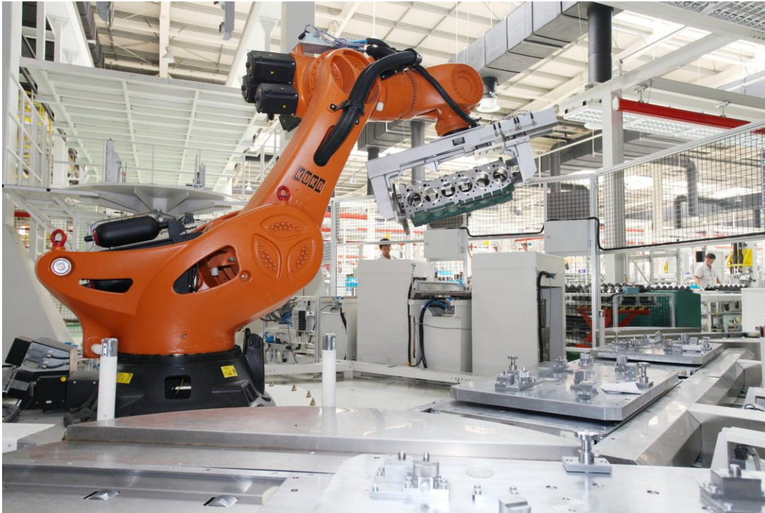
Foto 2: Ein Greifer des Typs 2 beim Handhaben eines Zylinderblocks, in den bereits eine Kurbelwelle eingesetzt wurde.
