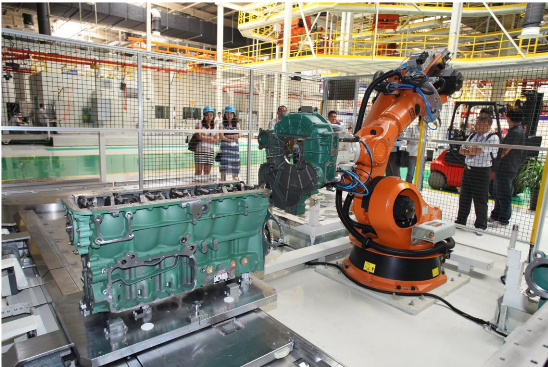
Foto 3: Ein Greifer für die Handhabung und Montage des Schwungscheibengehäuses: An der blauen Verschlauchung ist einer der Schrauber angeschlossen.
